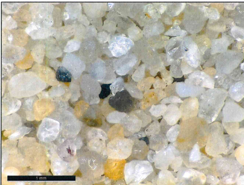
Bild 1 : Mikroskopische Aufnahme der Körnung 0/1 mm aus dem Werk Datteln-Ahsen.
